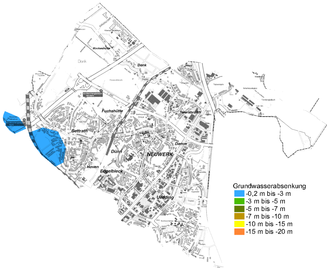
Abb. 24 Bergbaubedingte Grundwasserabsenkung im Bezirk Neuwerk (Oberster Leiter)
